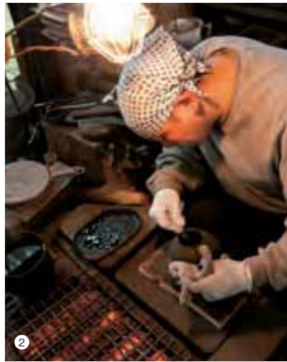
1.山形鑄物の歴史を語る菊地さん。2.伝統的な鉄瓶に錆び止めの漆を塗る職人。3.成形したポットを一つずつ丁寧に研磨していく。4.角の部分を丸くした、やわらかな雰囲気ティーポット。5.さまざまな工程を経て、丁寧に仕上げられる。6.山形の砂は粒子が非常に細かいため、繊細な造形ができる。写真は伝統的な「青海波」の模様。
