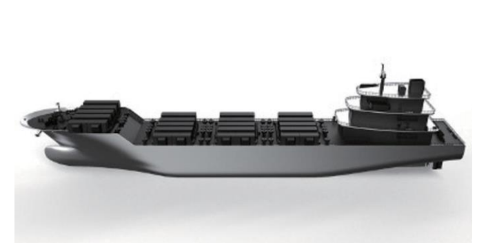
2027年からの商業運航をめざす世界初の電気運搬船「Power Ark 100」の初号船「X」。コンテナ化された船舶用バッテリーを96個搭載し、総容量240MWhを実現する。
